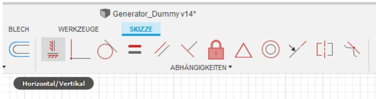
14. Vergeben Sie eine Vertikal Abhängigkeit für die erstellte Mittellinie.
