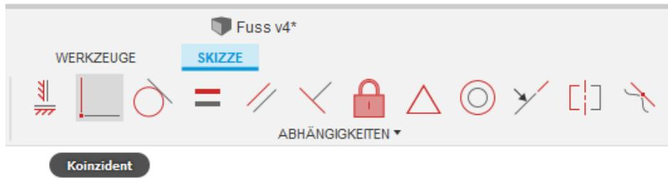
10. Vergeben Sie Koinzident Abhängigkeiten zum Mittelpunkt des Zylinders wie im unteren Bild dargestellt.
