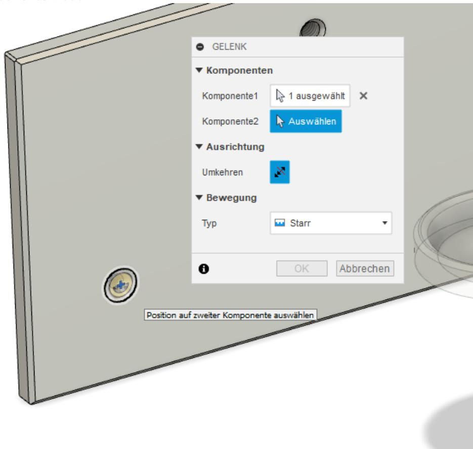
4. Vergewissern Sie sich, dass die Komponente Halter die richtige Ausrichtung hat. Wenn nein, drücken Sie den **Umkehren** Button. Vergewissern Sie sich, dass der **Typ=Starr** ausgewählt ist, und verlassen Sie den Befehl mit **OK**.
