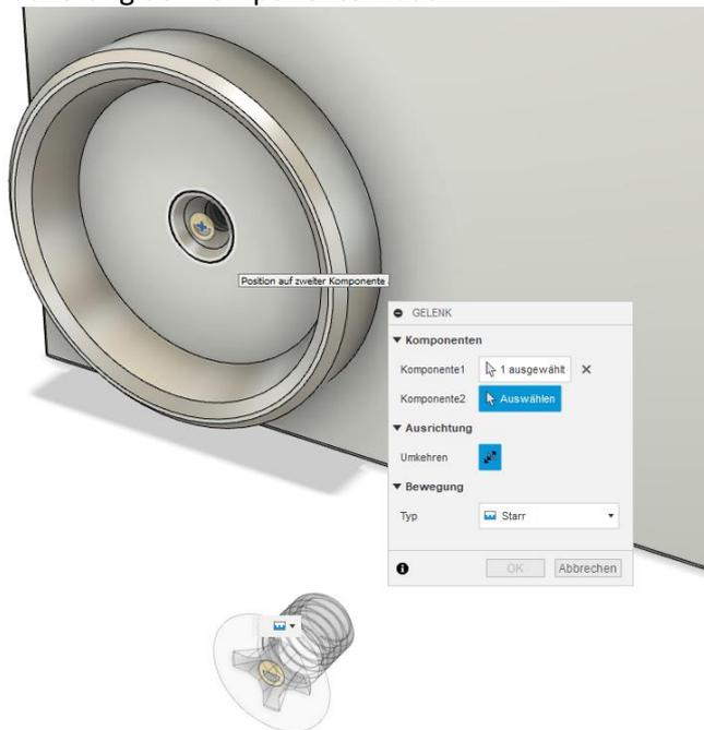
4. Vergewissern Sie sich, dass die Schraube die richtige Ausrichtung hat. Wenn nein, drücken Sie den **Umkehren** Button. Vergewissern Sie sich, dass der **Typ=Starr** ausgewählt ist, und verlassen Sie den Befehl mit **OK**.
